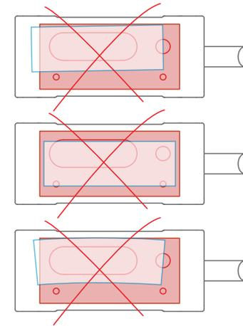
Wenn nach dem Aufkleben Luftpinschlüsse zwischen der Schutzfolie und der Glasscheibe verbleiben, versuchen Sie nicht diese zu entfernen (rausstreichen). Entfernen Sie die Schutzfolie wieder und beginnen Sie mit einer neuen Schutzfolie im Abschnitt *Vorbereitung*.
